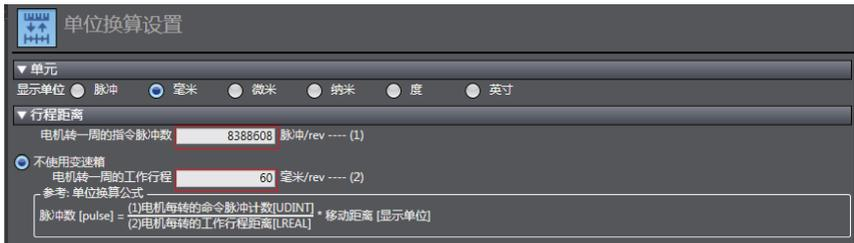
实际使用者中，根据负载实际运行单位，选择“显示单位”，设置齿轮比，上位机中所有位置类参数与按此单位显示。
