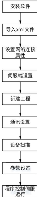
图2-10 SV660N配合欧姆龙控制器配置流程图
